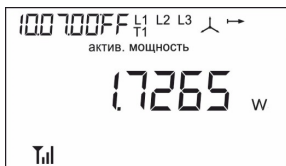
Рис. 11 Меню 10 кадр 1. Мощность активная всего, в Вт
