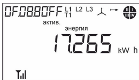
Рис. 8 Меню 1 Кадр 1. Энергия активная нарастающим итогом всего, в кВт·ч
